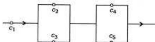
दिया गया है कि अवयवों  $c_1, c_2, c_3, c_4$  तथा  $c_5$  की अवयव विश्वसनीयताएँ क्रमशः 0.6, 0.4, 0.7, 0.8 तथा 0.5 हैं।
